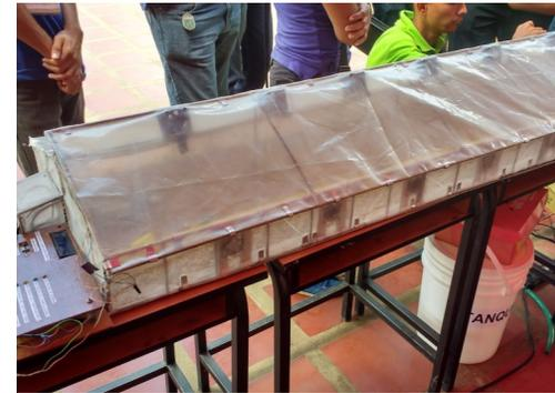
Sistema para el control de la temperatura de plántulas por pic | Foto NR
